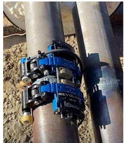
Die neu entwickelte Methode zur Prüfung von dünnwandigen Schweissverbindungen, ist eine effiziente, umweltfreundliche und wirtschaftliche Lösung zur Prüfung der Schweissnähte von Fernwärmeleitungen mit Ultraschall. Die Prüfdaten werden positionsgenau aufgenommen und abgespeichert.
